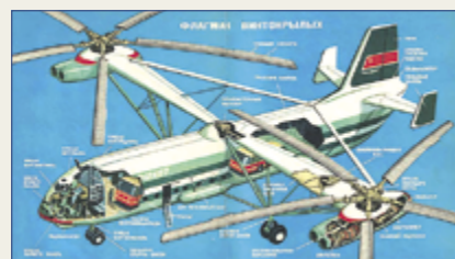
Проект вертолёт В-12 поперечной двухвинтовой схемы с двумя ГТД
