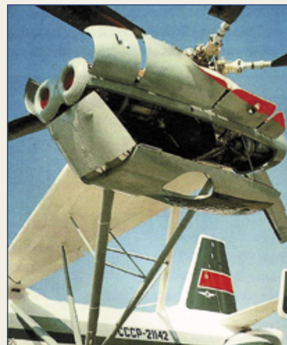
Проект вертолёт В-12 поперечной двухвинтовой схемы с двумя ГТД
