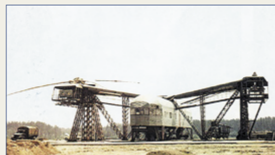
Испытательный стенд вертолёт В-12
