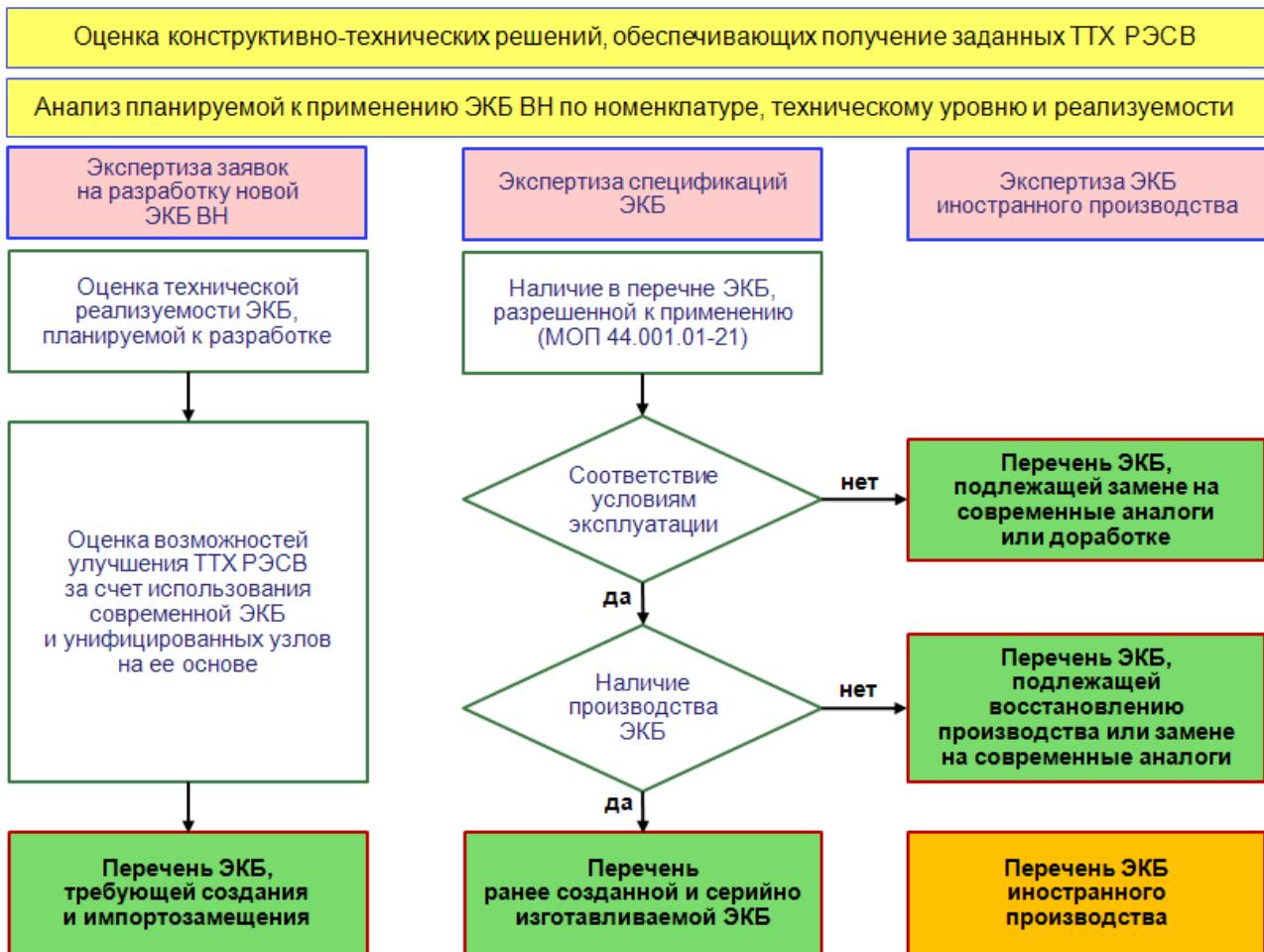
Рисунок 4 – Алгоритм проведения экспертизы обоснованности выбора ЭКБ ВН
