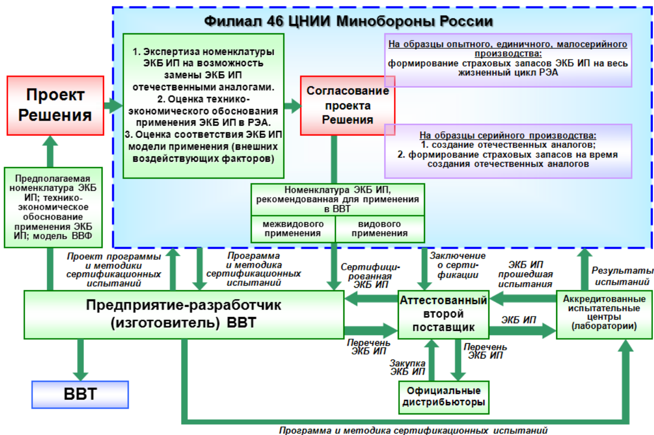
Рисунок 6 – Порядок проведения экспертизы правильности выбора ЭКБ иностранного производства в образцах ВВТ
