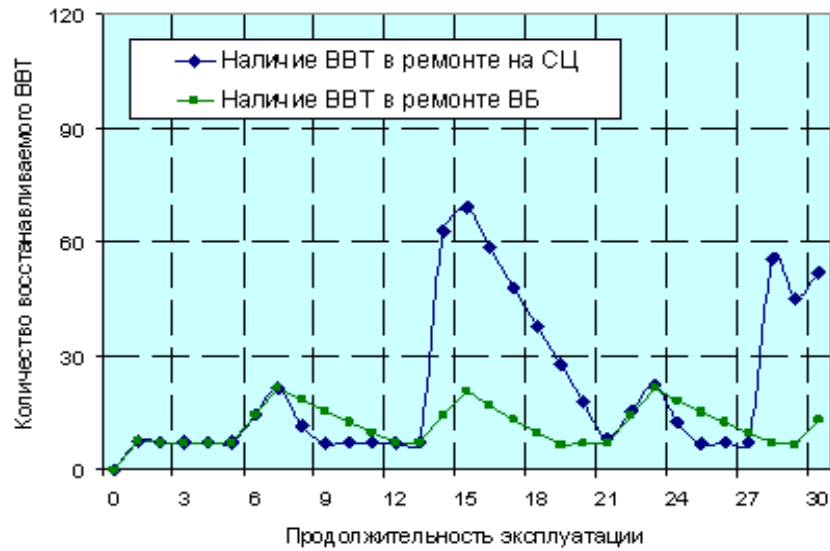
Рисунок 10 – Динамика восстановления ВВТ по текущему и капитальному ремонту
