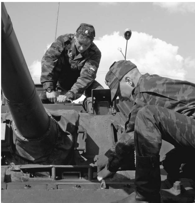
Проверка целостности сварных соединений, замков, защелок, уплотнений крышек люков.
