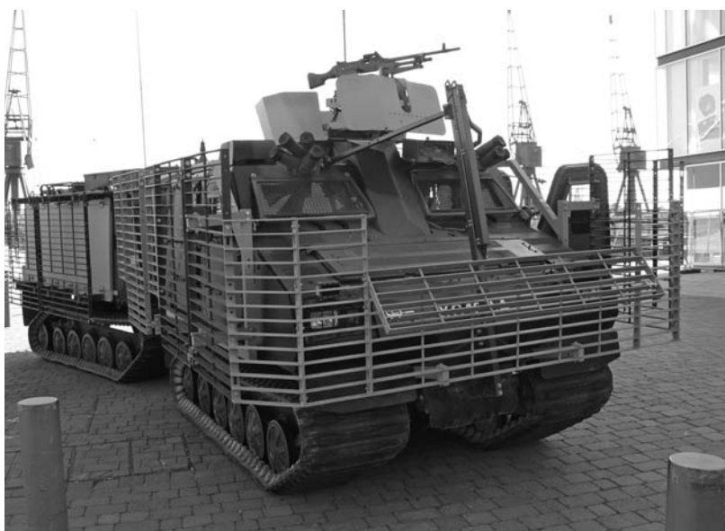
Вариант защиты двухзвеного БТР Vv206 шведского производства, состоящего на вооружении британской армии.
