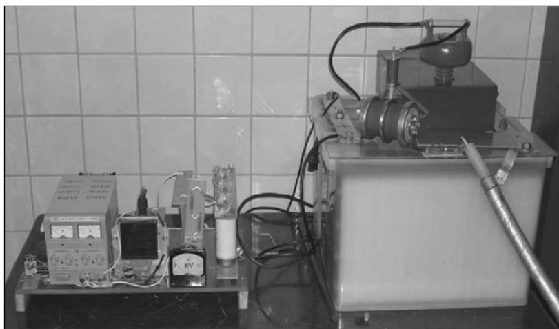
Экспериментальная установка измерения электрогидравлического удара ЭГУ
