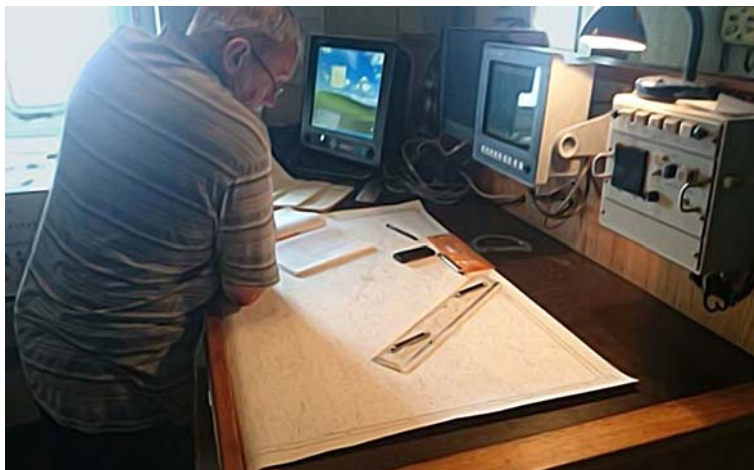
Рис. 6. Вахтенный гидрограф у навигационного эхолота «НЭЛ-1000М»
