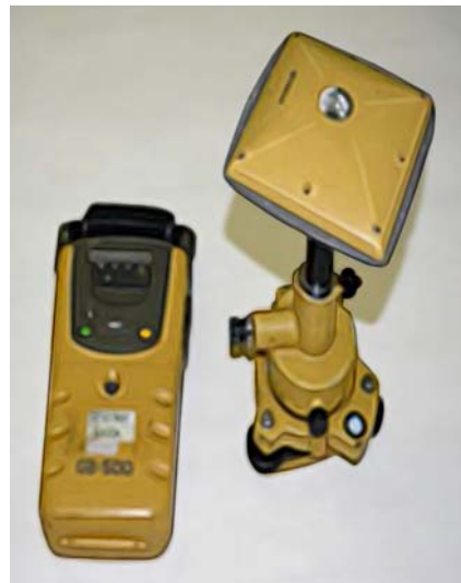
Рис. 10. Аппаратура позиционирования по CHC GPS «Topcon GB-500»
