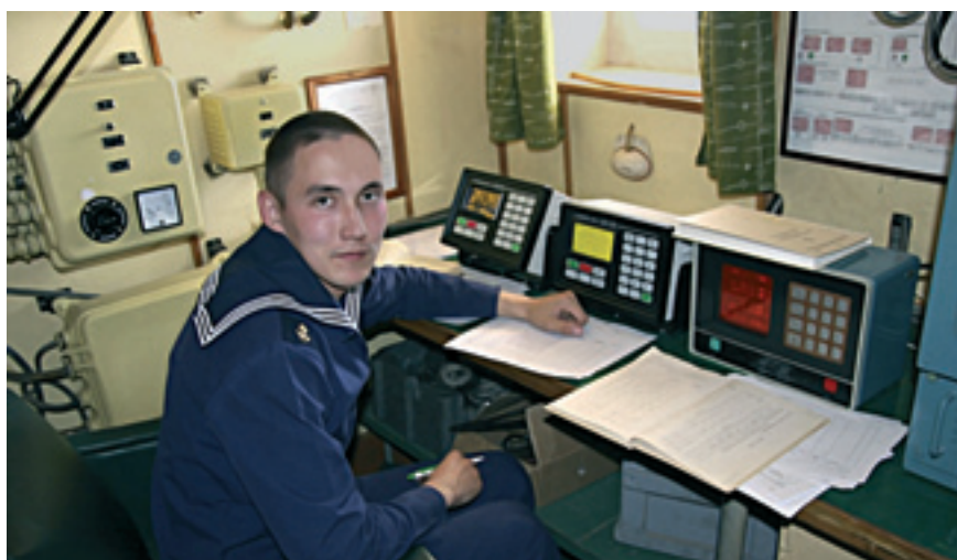
Рис. 2. Снятие отсчетов ПИ РНС курсантом Военно-морского института
