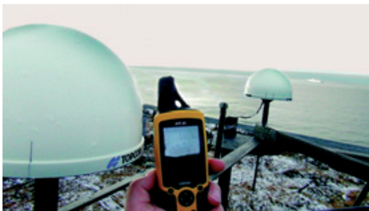
Рис. 12. Проверка привязки антенн ККС острова Столбовой
