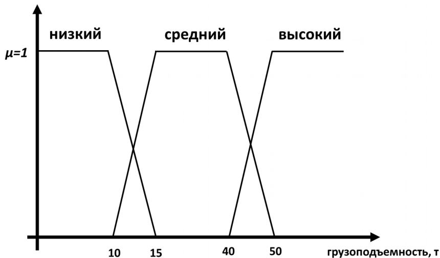
Рисунок 4 – Функция принадлежности грузоподъемности автокрана ( \mu=1 – максимальное значение функции принадлежности)
