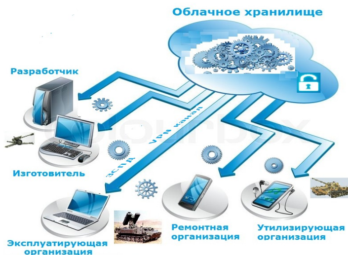
Рисунок 2 – Схема взаимодействия участников реализации жизненного цикла ВВТ с облачным хранилищем данных
