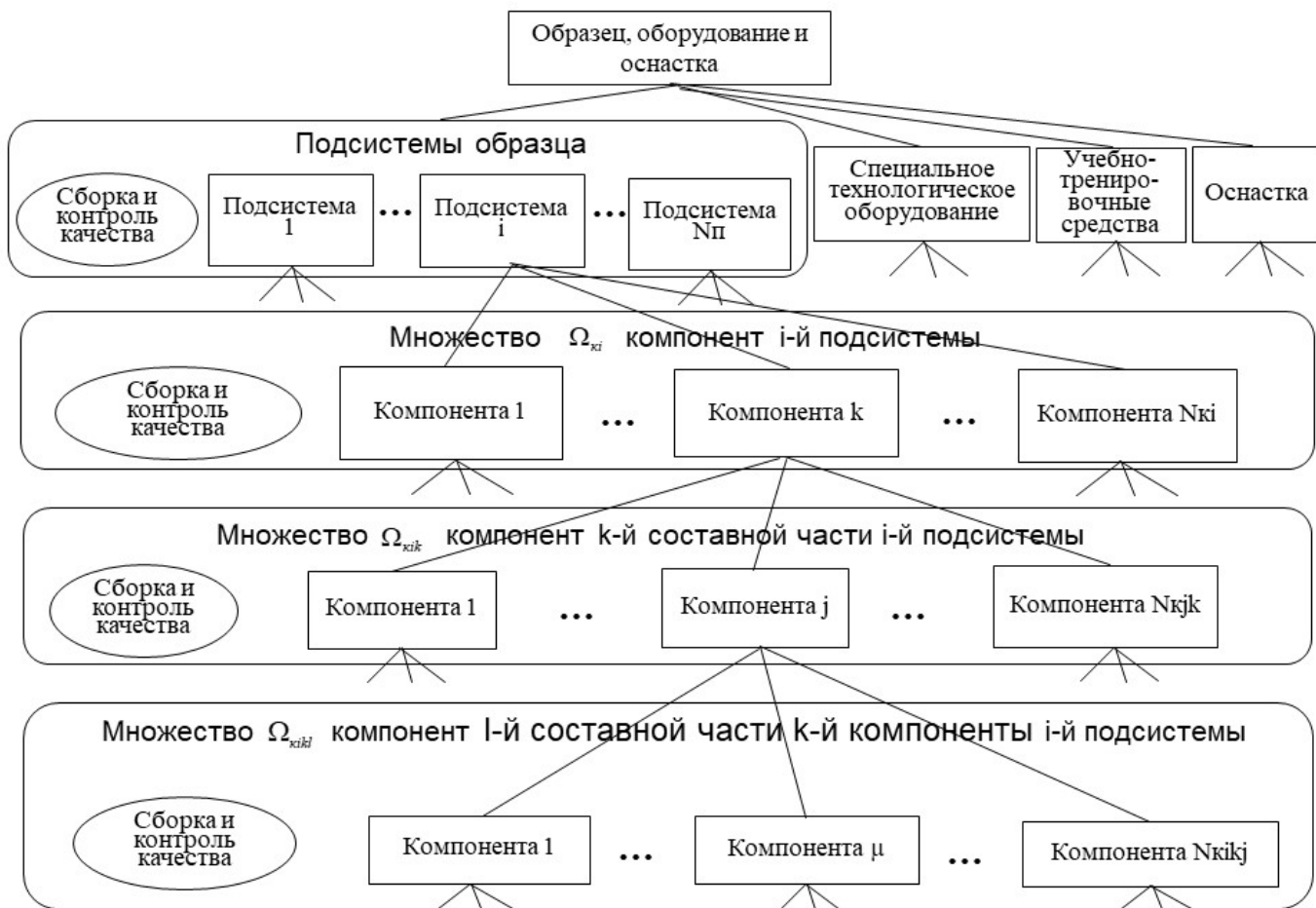
Рисунок 3 – Структурная схема декомпозиции образца, технологического оборудования и оснастки на составные части
