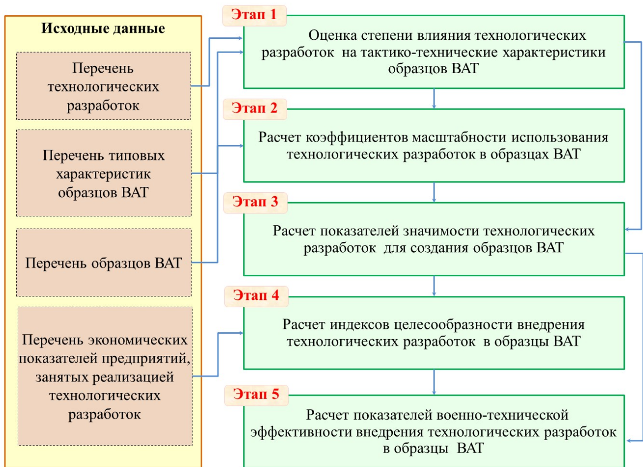
Рисунок 1 – Алгоритм оценки военно-технической эффективности внедрения технологических разработок в образцы ВАТ
