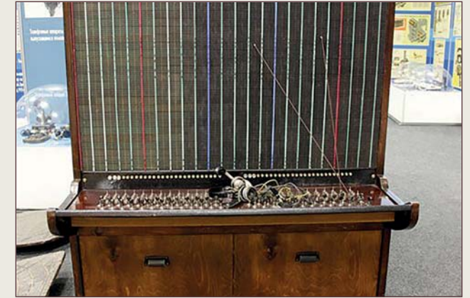
▲ Настенный и стационарный телефонные коммутаторы фирмы Л.М. Эриксона, 1900-х гг.
