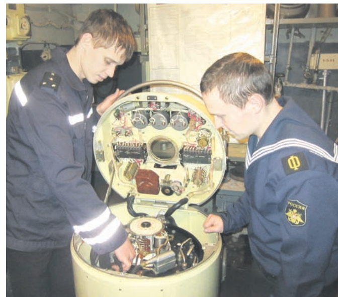
Командир БЧ-1 капитан-лейтенант Д. Завгородний и штурманский электрик матрос Е. Люсов проводят осмотр гирокомпыса.
