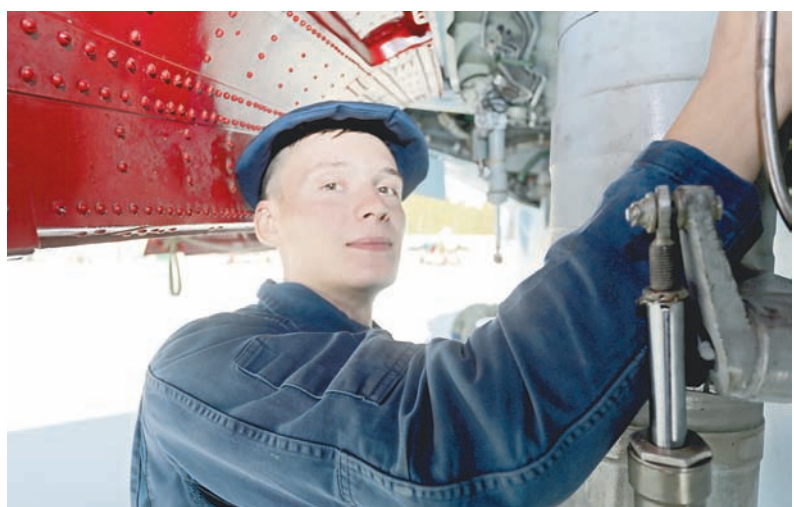
Инженер авиационного комплекса лейтенант А.Соловкин за заменой подкоса подъёмника, говоря простым языком, меняет стойки истребителя.
