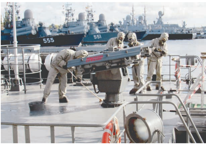
Обработка верхней палубы от последствий условной радиационной аварии.
