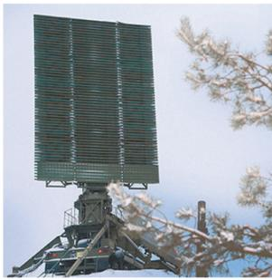
В этом месяце в рамках гособоронзаказа предприятие-изготовитель передаст подразделениям Северного флота шесть комплектов РЛК «Сопка-2» – автоматизированный твёрдотельный трёхкоординатный трассовый радиолокационный комплекс двойного назначения. Он предназначен для использования в качестве источника радиолокационной информации для систем управления воздушным движением и контроля воздушного пространства.
