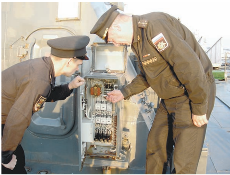
Командир БЧ-5 капитан-лейтенант А.Евдокимов (справа) производит осмотр щита управления якорным шпилем.
