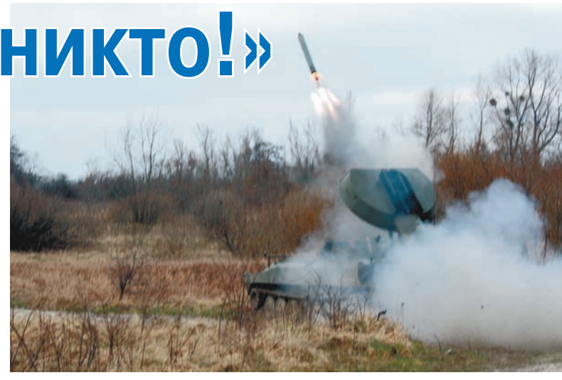
За работой самоходная реактивная установка разминирования УР-77 «Метеорит».
