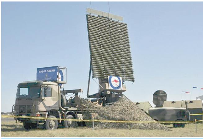
Буксируемая радиолокационная станция AN/TPS-77 предназначена для обнаружения воздушных целей на дальности до 400 км и высотах до 30 км. РЛС может транспортироваться грузовиком и разворачиваться в течение 30 мин. Ориентировочный срок эксплуатации станции составляет 15 лет.
