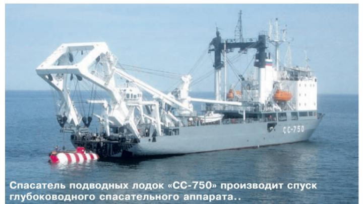
Спасатель подводных лодок «СС-750» производит спуск глубоководного спасательного аппарата.
