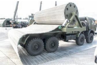
Инженерными войсками принят на снабжение комплекс оперативного развёртывания временных дорог. Он предназначен для пропуски колёсной и гусеничной техники на труднопроходимых и заболоченных участках местности, а также на подходах к переправам и мостам. Это достигается за счёт применения новых высокопрочных и лёгких материалов для дорожного покрытия, а также благодаря разработанной оригинальной конструкции механизма его укладки на поверхность грунта.
