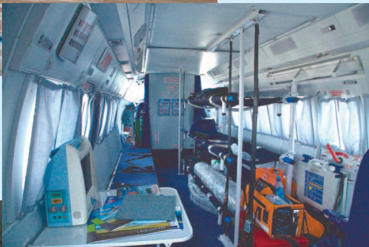
Рис. 2. Самолет Л-410 в санитарном варианте с заводской комплектацией оборудования
