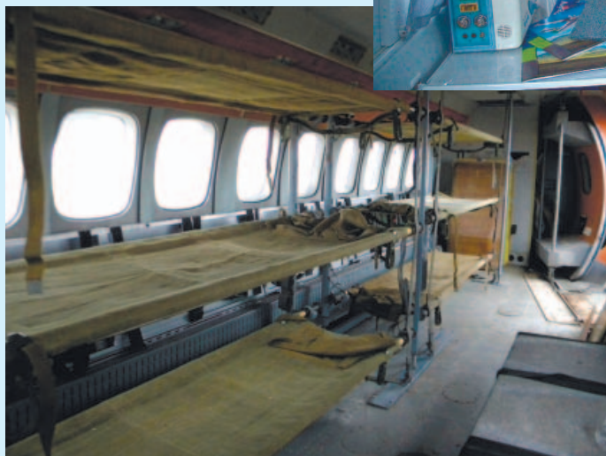
Рис. 3. Вид установленного транспортно-санитарного оборудования на самолете Л-410 уvp-э
