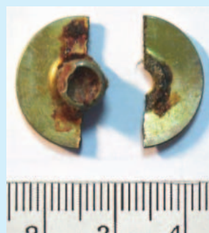
Рис. 2. Фрагменты гайки крепления подтулейного устройства защитного шлема
