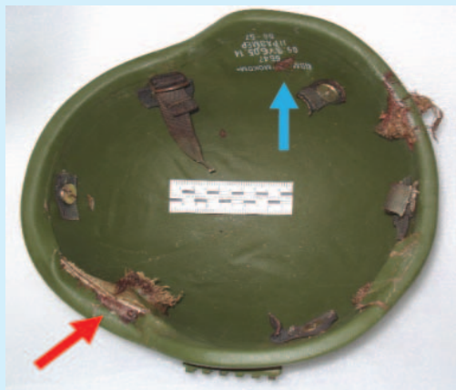
Рис. 4. Входное сквозное повреждение в корпусе защитного шлема (отмечено красной стрелкой), несквозное повреждение на внутренней поверхности шлема, образованное фрагментированными частями пули (синяя стрелка)
