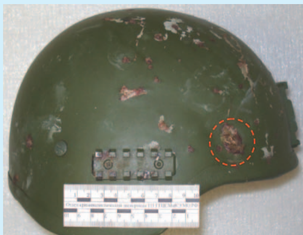
Рис. 3. Сквозное повреждение в корпусе защитного шлема (отмечено красным пунктиром)
