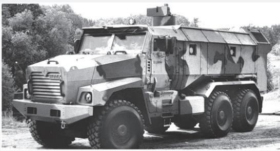
В этих машинах впервые применяется интегрированная керамическая броня, противоминная защита, включающая в себя особые кресла для экипажа и десанта, специальное остекление, которые могут выдержать прямое попадание бронебойно-зажигательной пули из станкового пулемета крупного калибра КПВТ с расстояния 200 метров.
