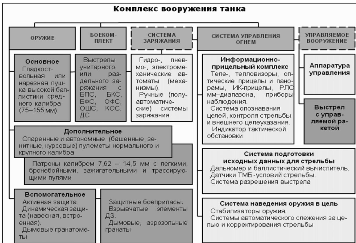
**Рис. 1. Типовой состав комплекса вооружения современного основного боевого танка**
