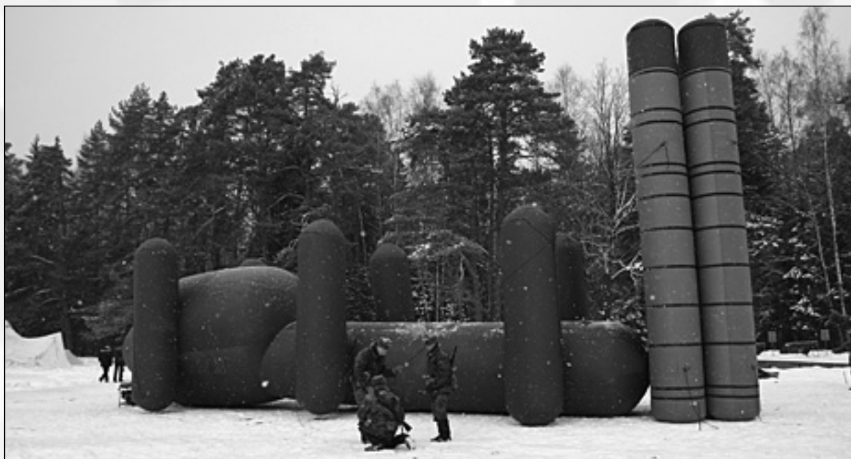
Современные средства маскировки имитируют не только габариты техники, но ее тепловые и звуковые характеристики
