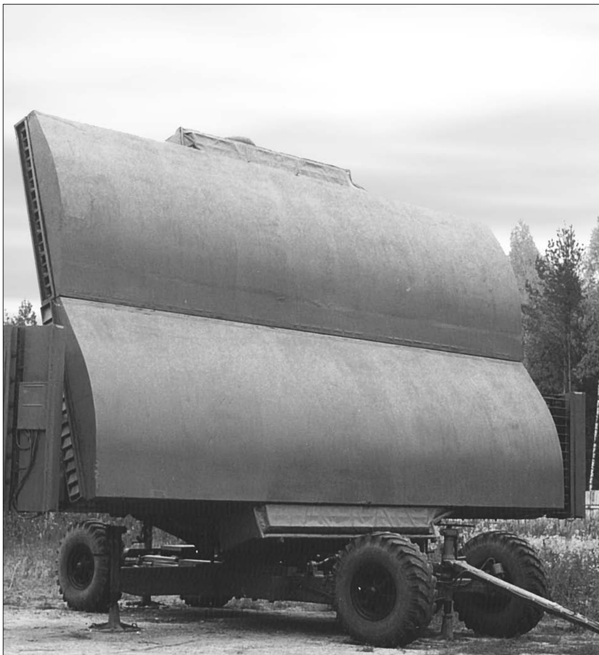
Мобильная трехкоординатная высокопотенциальная станция средних и больших высот с активной ФАР «Гамма-ДЕ»
