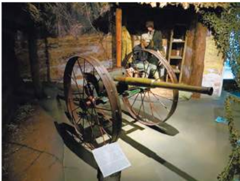
Рис. 9. Передвижная пушка, сделанная из орудия танка Т-26
