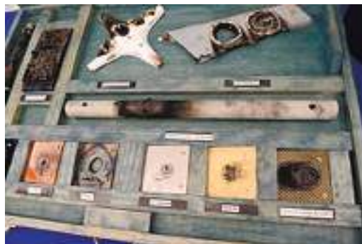
Рис. 4. Примеры воздействия на различные материалы современных боевых американских лазеров
