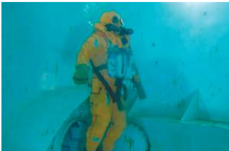
Рис. 5. Опытная эксплуатация спасательного снаряжения подводника нового поколения на экспериментальной научно-исследовательской базе института (выход через макет торпедного аппарата способом свободного всплытия)
