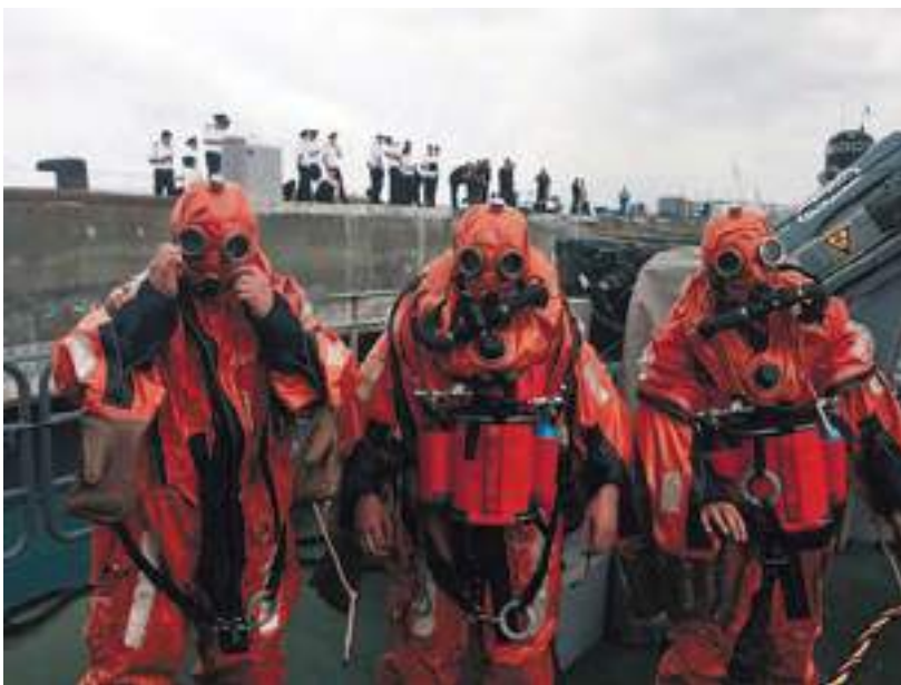
Рис. 4. Морской этап опытной эксплуатации спасательного снаряжения подводника нового поколения (после выхода через торпедный аппарат подводной лодки «Старый Оскол»)
