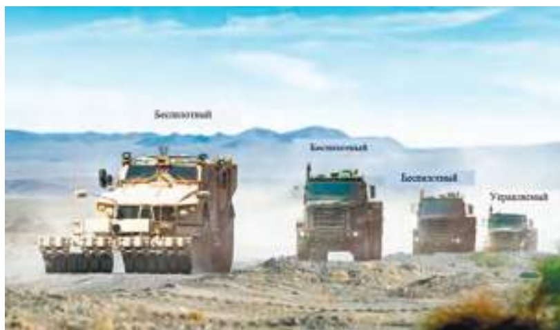
Рис. 3. Роботизированный комплекс на базе броневедомо-мобиля Oshkosh с системой TerraMax M-ATV во главе колонны безэкипажных машин
