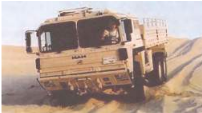
Рис. 1. Полноприводные многоцелевые автомобили MAN (Германия) (электронная система управления впрыском топлива; автоматическая трансмиссия; антиблокировочная система тормозов; электронная система регулирования давления в шинах; защита электроники от радио- и электромагнитных помех; встроенная диагностика систем электроники)
