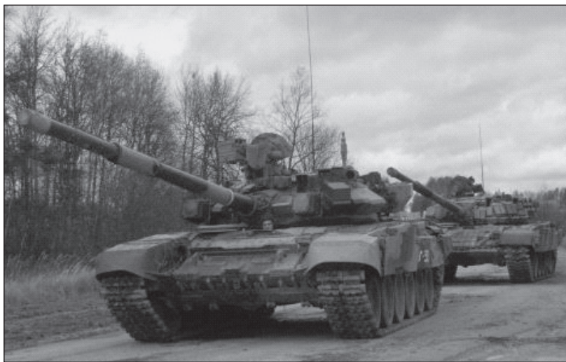
Т-90 с ДЗ «Контакт-5» (на переднем плане) и Т-72 с навесным комплексом ДЗ «Контакт» (сзади).
