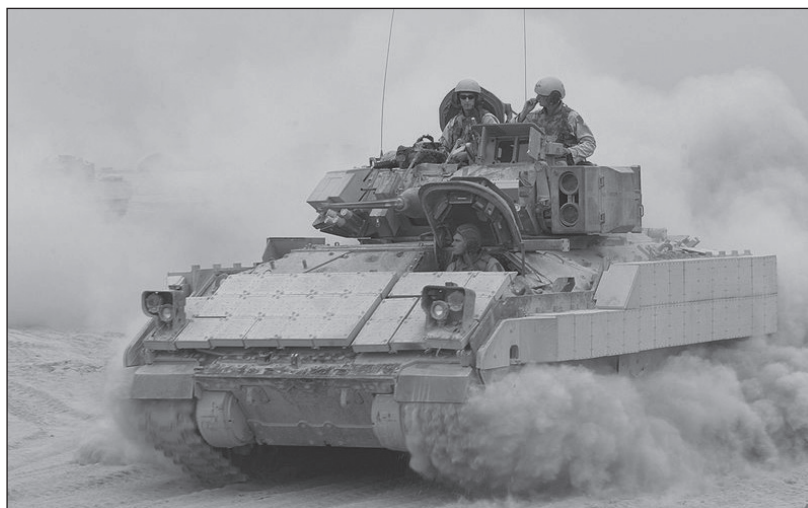
Рис. 3. Боевая машина пехоты M2A2 «Брэдли» с элементами динамической защиты на лобовой броне и по бортам
