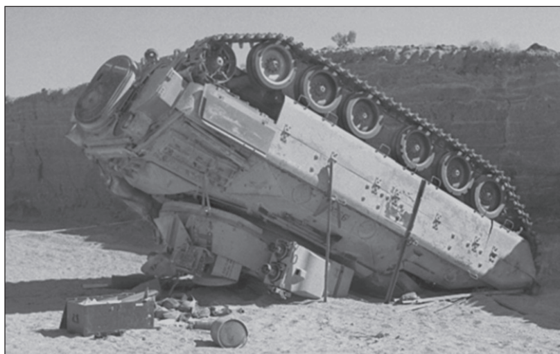
Рис. 5. Наличие самых современных приборов ночного видения не гарантирует успешное выполнение задачи. Механик-водитель данной БМП M2A2 «Брэдли», ведя ночью машину с помощью прибора ночного видения, принял пятиметровый обрыв за узкую канаву
