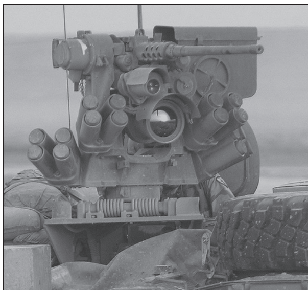
Рис. 4. Дистанционно управляемый боевой модуль M151 «Protector» (слева) и органы управления им (справа)
