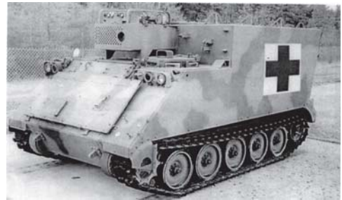
Рис. 2. БММ М577 на базе плавающего БТР М113
