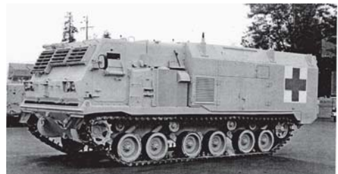
Рис. 3. БММ на базе многофункционального гусеничного тягача ХМ987
