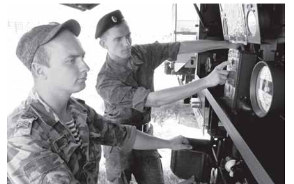
Лейтенант В. Капитанчук и сержант Д. Иваница. Вывод автозаправщика на режим перекачки.
