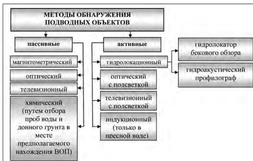
Рис. 1. Основные методы обнаружения взрывоопасных предметов в водной среде
