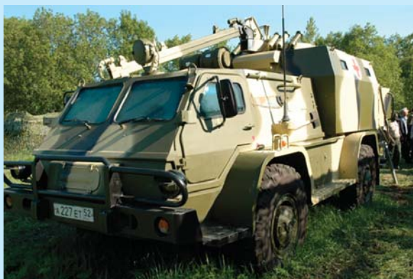
Рис. 4. БММ на базе ГАЗ-3937: эвакуационная вместимость – 10 человек, скорость движения по шоссе – 90 км/ч, по грунтовой дороге – 50 км/ч
