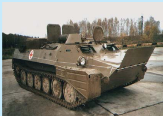
Рис. 3. Бронированный санитарный транспортер на базе МТ-ЛВБ: эвакуационная вместимость – до 10 легкокоряных
