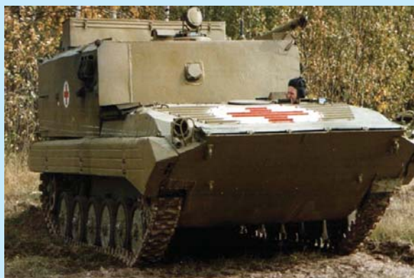
Рис. 2. БММ на базе БМП-1: эвакуационная вместимость – 12 человек, скорость движения по шоссе – 65 км/ч, по грунтовой дороге – 40 км/ч, на плаву – 7 км/ч
