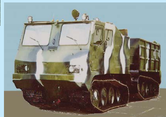
Рис. 5. БММ большой эвакуационной вместимости на базе двухосного транспортера ДТ-3ПБ
