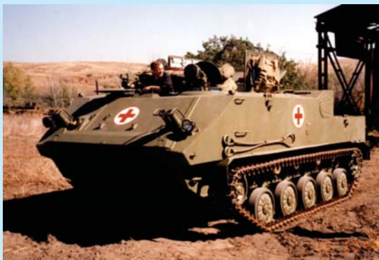
Рис. 1. БММ-Д на базе БМД-3: эвакуационная вместимость – 10 человек, скорость движения по шоссе – 70 км/ч, по грунтовой дороге – 40 км/ч, на плаву – 11 км/ч
