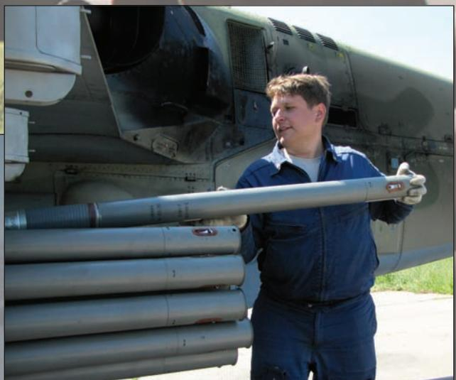
Унифицированный блок Б-8В20А для пуска неуправляемых авиационных ракет С-8. Заряжание ракетой С-8КОМ
