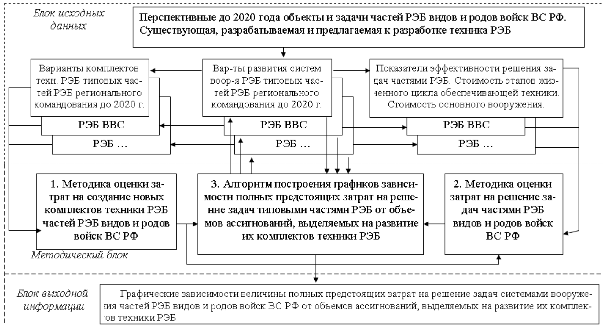
Рисунок 1 – Укрупненная блок-схема системы методик определения зависимости величины полных предстоящих затрат на решение задач РЭБ системами вооружения РЭБ частей РЭБ видов и родов войск ВС РФ от объемов ассигнований, выделяемых на развитие их комплектов техники РЭБ
