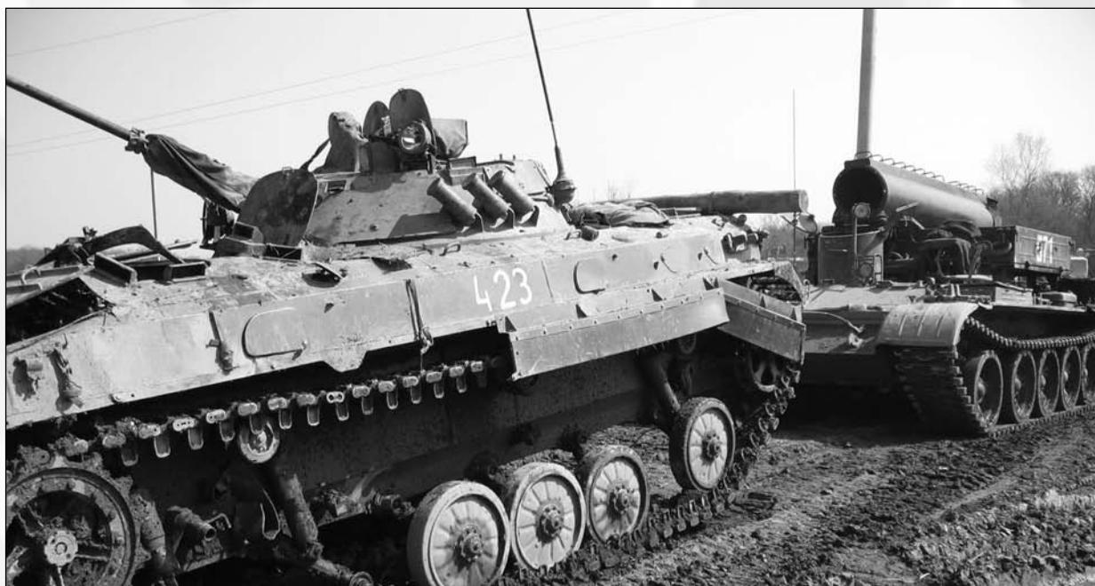
*Эвакуация боевой машины, поврежденной во время подрыва фугаса*
