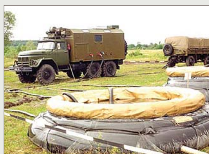
Фильтровальная станция МАФС-3
