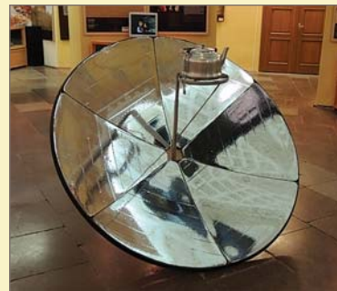
Китайское устройство ▲ для кипячения воды на солнце
